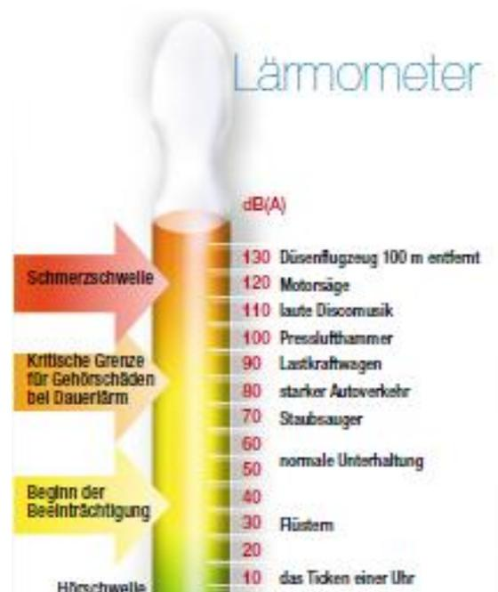
Abbildung 2 „Lärmometer“ (verschiedene Schallereignisse und deren Schalldruckpegel) [© Online-Informationsbroschüre des Amtes für Luft und Lärm, Bozen]
